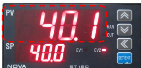
按下 Haeting 按鈕後，加熱器啟動，待自動溫控功能，將溫度提升至設定溫度。
